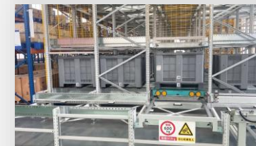
Intensive Ein- und Auslagerung mit Vier-Wege-Shuttles
