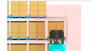
Erkennung des verfügbaren Absetzbereichs
